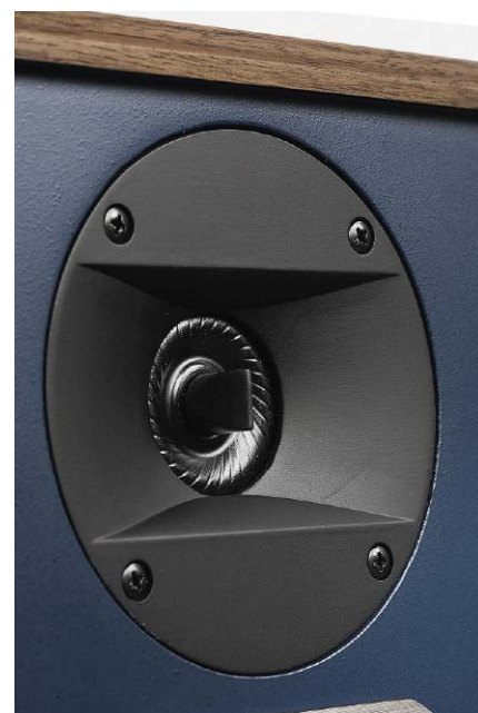
Przetwornik wysokotonowy ma membranę pierścieniową i miniaturową tubkę. Mimo to jego charakterystyka leży znacznie poniżej charakterystyki z przetwornika średniotonowego.
